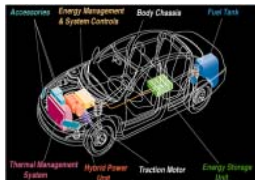
圖 3 複合動力車元件圖
