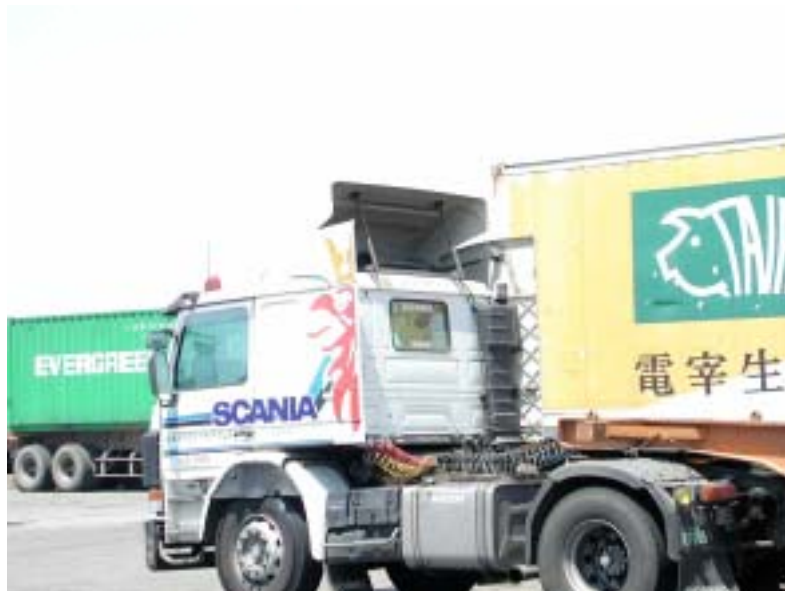
圖 6. 3D 不可調式導風板 (導風板下方三個圓洞即為扣件固定位置)
