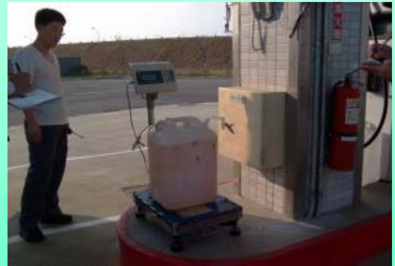
電子磅秤量秤燃油重量
